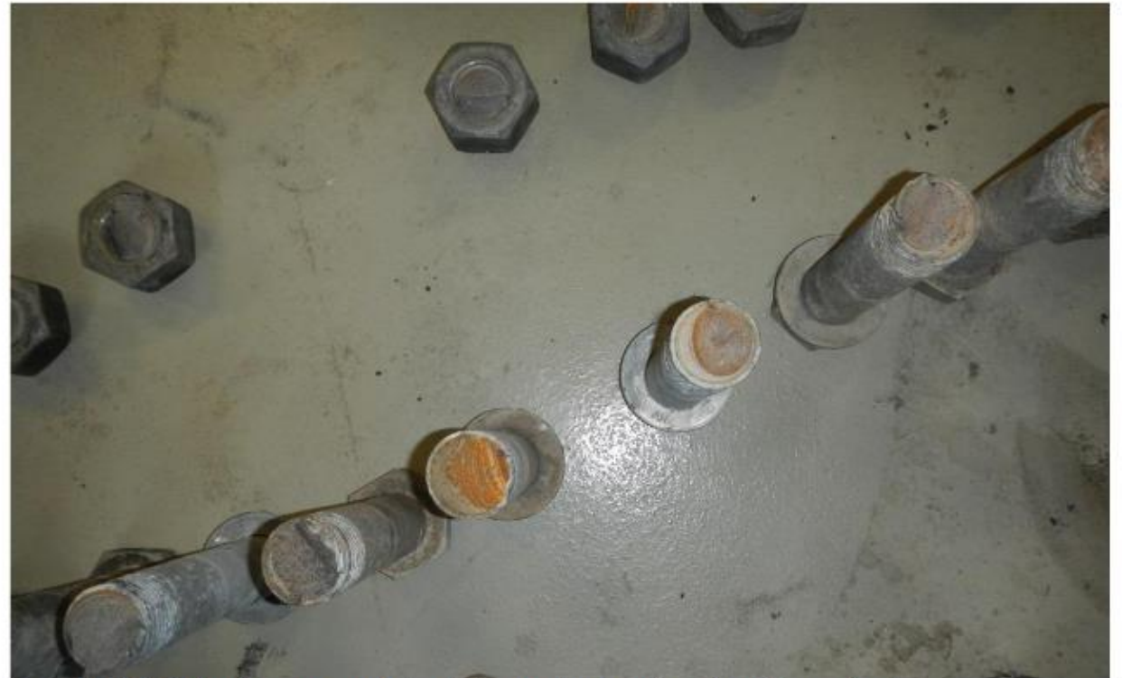
Figur 14. Bild på tornskruvarna med utmattningsbrott och varierande grad av restbrott.
