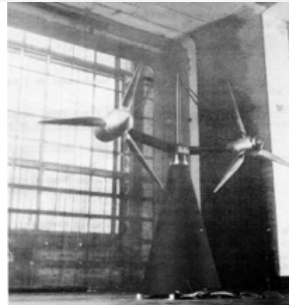
Maquette d'ensemble de 2 machines de 2 MW équipées d'hélices de 45 m en cours d'essais en soufflerie (Bréguet à Villacoublay)
