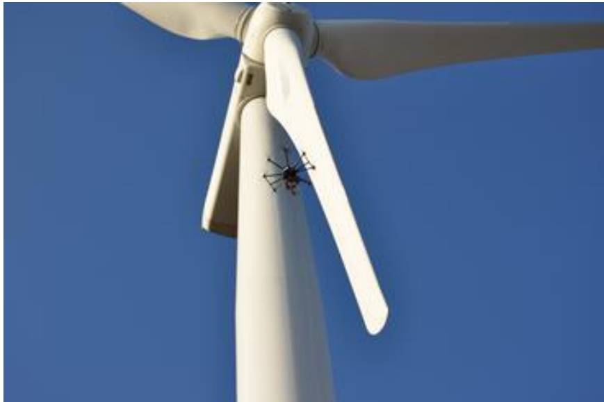
Bild 6: Kontroll av bladvärmens funktion med hjälp av minihelikopter utrustad med värmekamera. Foto: Lars Liljenfeldt, Swerea SICOMP.
