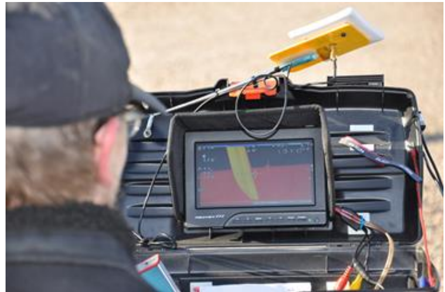
Bild 6: Kontroll av bladvärmens funktion med hjälp av minihelikopter utrustad med värmekamera. Foto: Lars Liljenfeldt, Swerea SICOMP.
